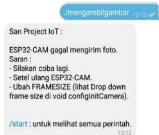
Gambar 6 Pengujian respon mengambil gambar jika gagal
