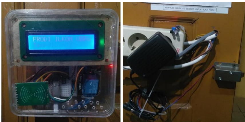
Gambar 6. Alat kunci pintu menggunakan RFID dan Infrared
